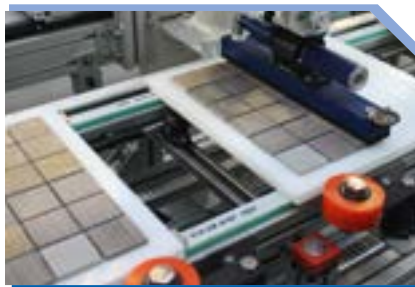
Riga aspirante 4x30 cm Suction line 4x30 cm Linea aspirante 4x30 cm Ligne aspirante 4x30 cm
